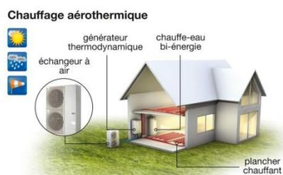
aussi la plus facilement accessible. Capturer de l'air extérieur est donc très peu coûteux. Par contre, vu la quantité d'énergie que l'on souhaite récupérer, il est souvent nécessaire de recourir à une captation dynamique au moyen d'un brassage d'une grande quantité d'air, ce qui consomme de l'énergie et génère un bruit parfois gênant (pour les voisins également). Un autre inconvénient non négligeable
